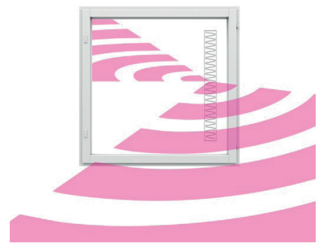
Kuva 3: Lasin pinnassa on huomaamaton antennikuvio. Tämä patentoitu ratkaisu mahdollistaa signaalien välittämisen sisälle huoneistoon.
